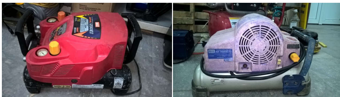
Máy nén khí không dầu: áp suất 43 bar
